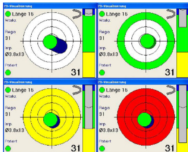
Abb. 9: Navigationsmodus: Der innere Kreis entspricht einer Abweichung von 0,5 mm und einer Angulation von 0,5 Grad.
