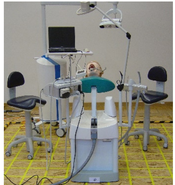
Abb. 4: Versuchsaufbau für die Ergonomie: Mit Hilfe der Messpunkte und des Koordinatensystems werden die Positionen der DSEplus inklusive Dummy und von MONA_DENT® reproduzierbar dokumentiert.
